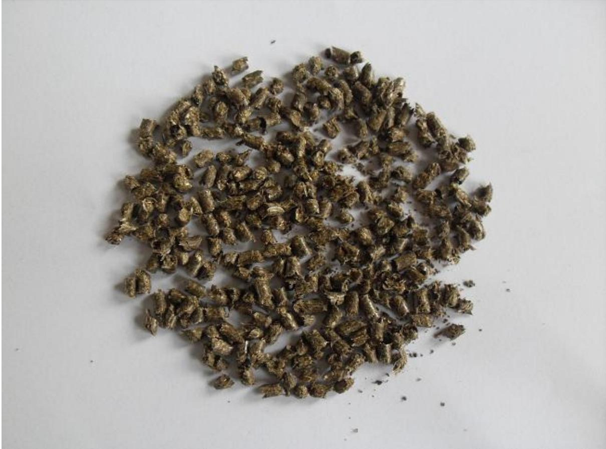
Il faut noter que les pellets doivent être assez durs pour supporter les manipulations d'emballage, de transport et d'alimentation, mais qu'ils doivent aussi se désintégrer facilement et complètement lors du mélange avec le polymère en fusion. Ils ne doivent donc être ni trop durs ni trop gros, des dimensions de l'ordre de 4-5 mm conviennent pratiquement.
